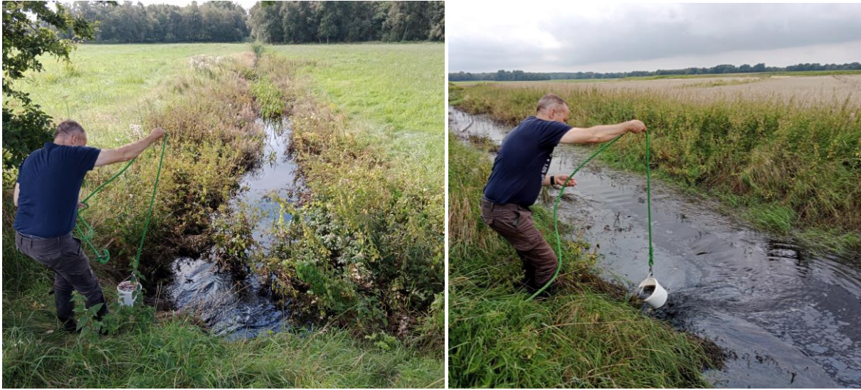
Abb. 17-18: Zwischen dem Auslauf aus dem Stellingsmoor (links) und dem nur 300 m stromab liegenden Abschnitt (rechts) sank der Sauerstoffgehalt der Bade am 15.8.2023 schlagartig von 0,420 mg/l auf 0,017 mg/l O 2 ab. Gleichzeitig färbte sich das Wasser von hellbraun-klar auf tiefschwarz (Fotos: Ralf Gerken / AVN).
