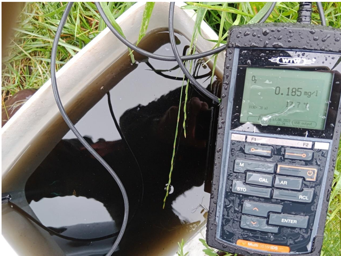
Abb. 113: Im sauerstoffarmen Wasser wurde in erheblichem Umfang Mangan rückgelöst, das zu einer intensiven Schwarzfärbung der verunreinigten Gewässer führte (Foto: Ralf Gerken / AVN).
