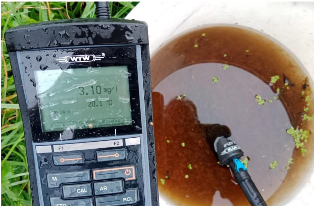
Abb.5: Die Sauerstoffmessungen wurden mit einem professionellen Messgerät mit optischen Sauerstoffsensoren durchgeführt. Zur Absicherung der Messgenauigkeit wurden die Messwerte der verwendeten Geräte mehrfach mit baugleichen Geräten verifiziert (Foto: Ralf Gerken / AVN).
